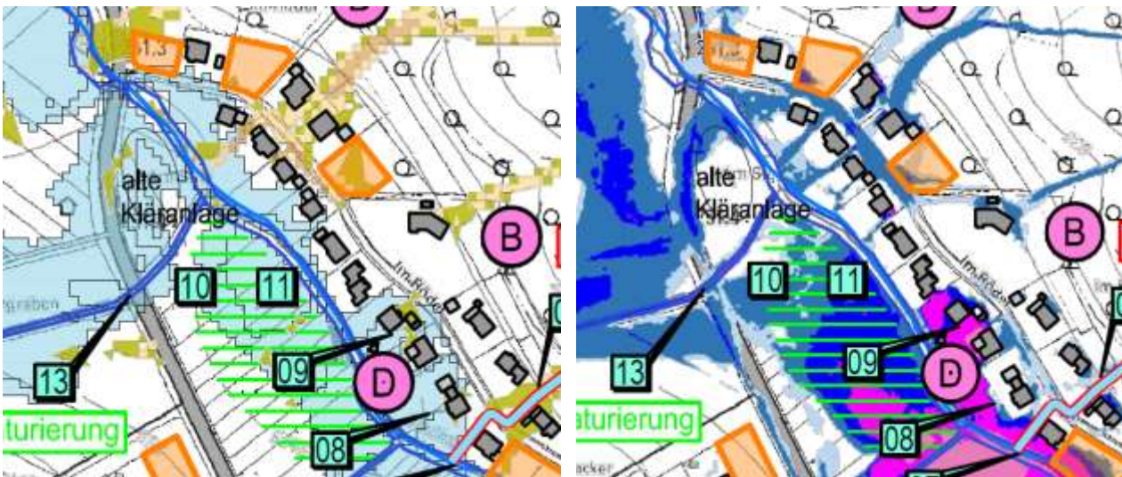
Abbildung 10: Starkregenabflusskarte (links) und Sturzflutgefahrenkarte (rechts)
