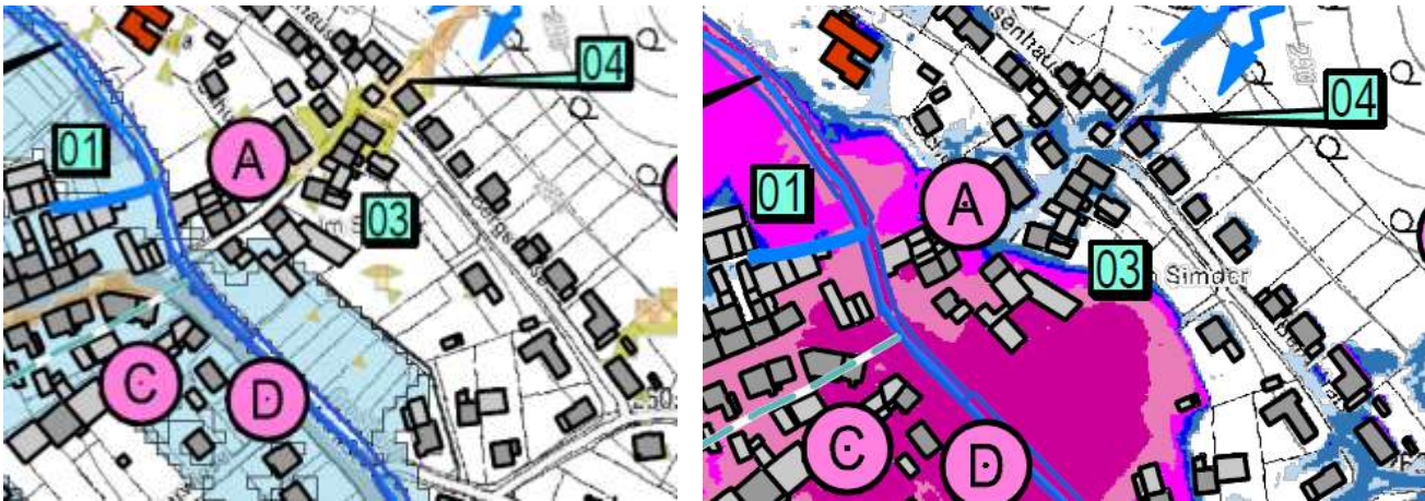
Abbildung 3: Starkregenabflusskarte (links) und Sturzflutgefahrenkarte (rechts)
