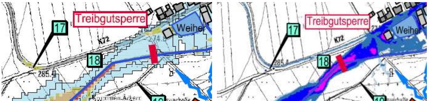
Abbildung 15: Starkregenabflusskarte (links) und Sturzflutgefahrenkarte (rechts)
