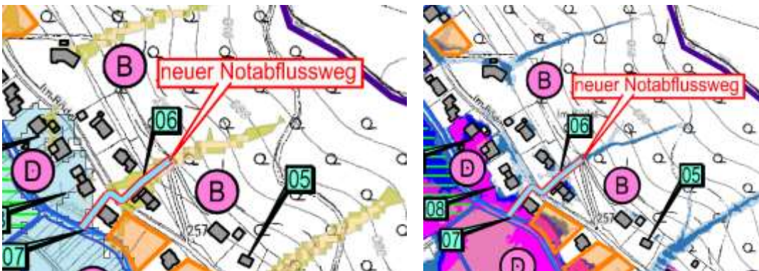
Abbildung 6: Starkregenabflusskarte (links) und Sturzflutgefahrenkarte (rechts)
